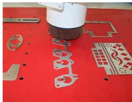
Специално покритие на масата с високо сцепление за добро закрепване на детайлите
