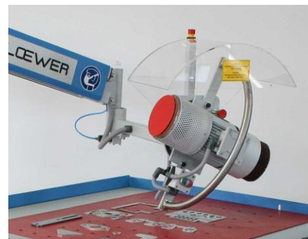
180° завъртане на работния агрегат, за бърз достъп консуматив за остраняване на заусенъци или заерване на ръбове.
